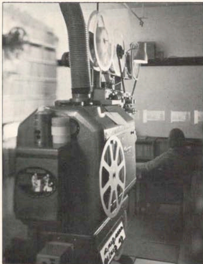
Die erste Kopie wird auf Schärfe, Farbbrillanz und Bildstand geprüft. Vor der Massenanfertigung sind jetzt noch Korrekturen möglich
