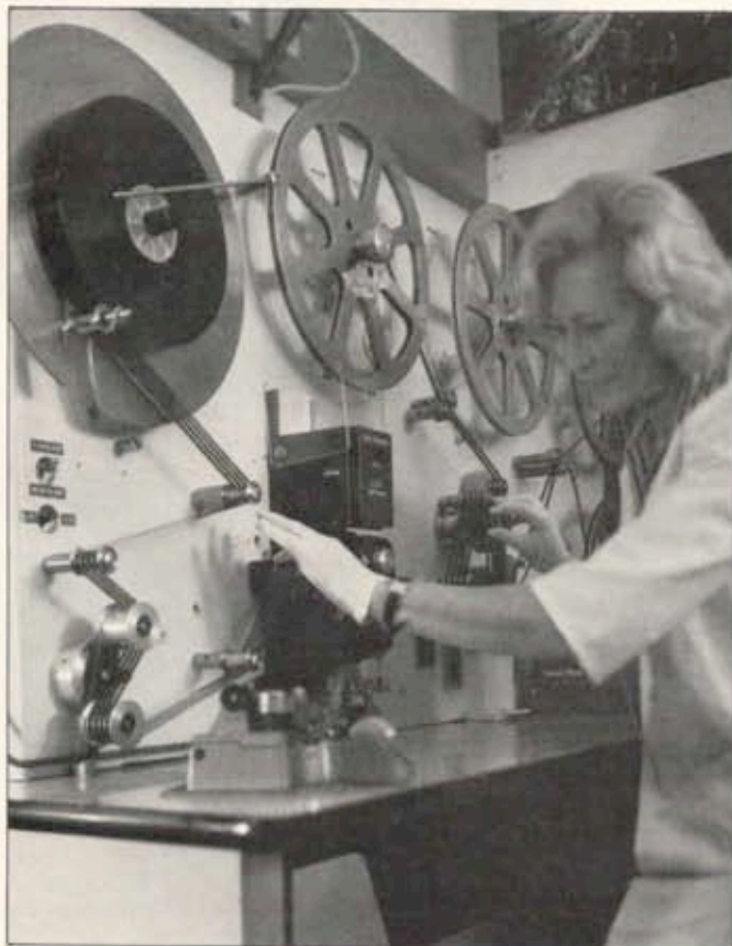
Das Filmband wird sorgfältig gesplittet und dann mit den Magnetspuren versehen zur Vertonung eingerichtet
